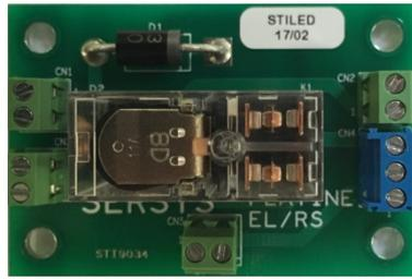
La carte EL/RS permet de convertir la serrure motorisée en serrure motorisée à sécurité positive. La batterie embarquée dans la serrure fournit l'énergie nécessaire à déverrouiller la serrure en cas de coupure de l'alimentation 12V branchée sur CN3.
